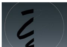
L'image illustre la résistance à la saleté (feutre à base d'huile) côté gauche. Sans revêtement fluoré côté droit.
